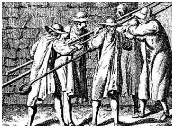
Vidrieros con sayos semejantes a los utilizados en Flandes para protegerse del fuego y del calor. Tomado de «A Diderot Pictorial Encyclopedia of Trades and Industry», año 1763.
